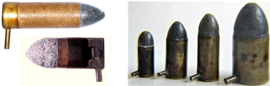
Cartuchos de espiga para escopeta y revólver. La semimetálica (culote de metal y vaina de cartón) del diseño Casimir Lefauchaux (1836) y la de culote y vaina de latón de Benjamin Houiller (1846)
