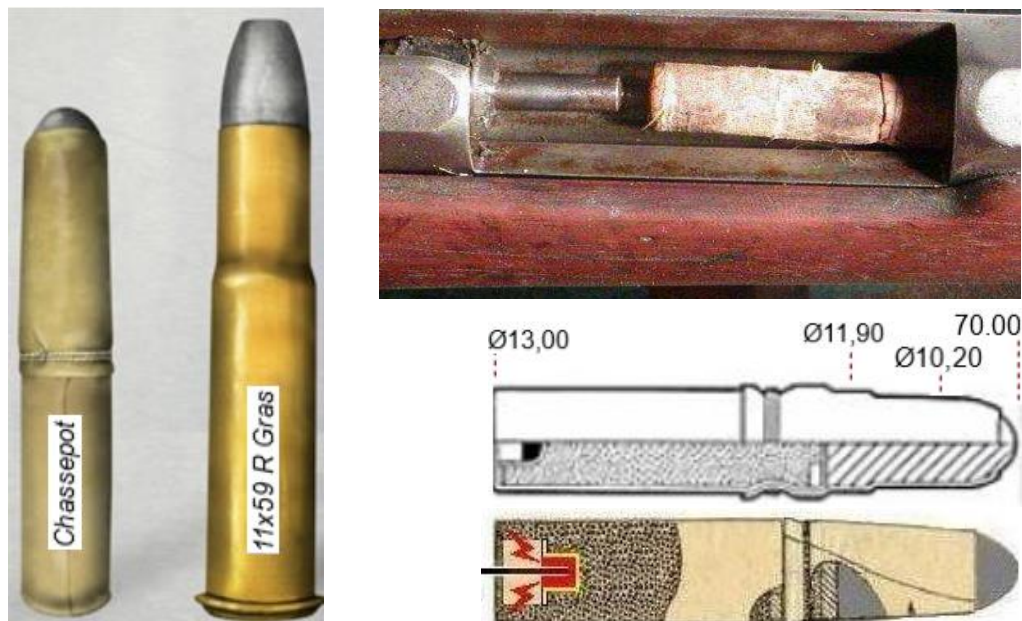
El fusil de aguja y cartuchos de papel con iniciador Chassepot 1866, fue el más "moderno" y anacrónico de los fusiles de su clase porque en 1866 ya se fabricaban numerosos tipos de municiones con vainas metálicas y semimetálicas
